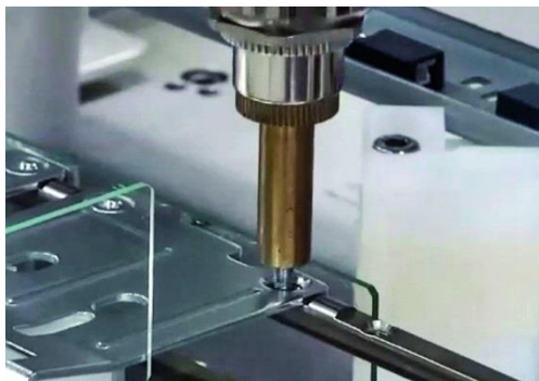
ShotMaster als Schraubroboter.
