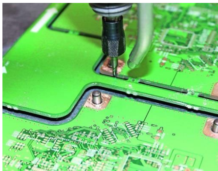
Nutzentrennen von Leiterplatten.
