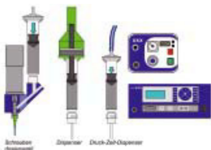
Schematische Darstellung herkömmlicher Dispenser
